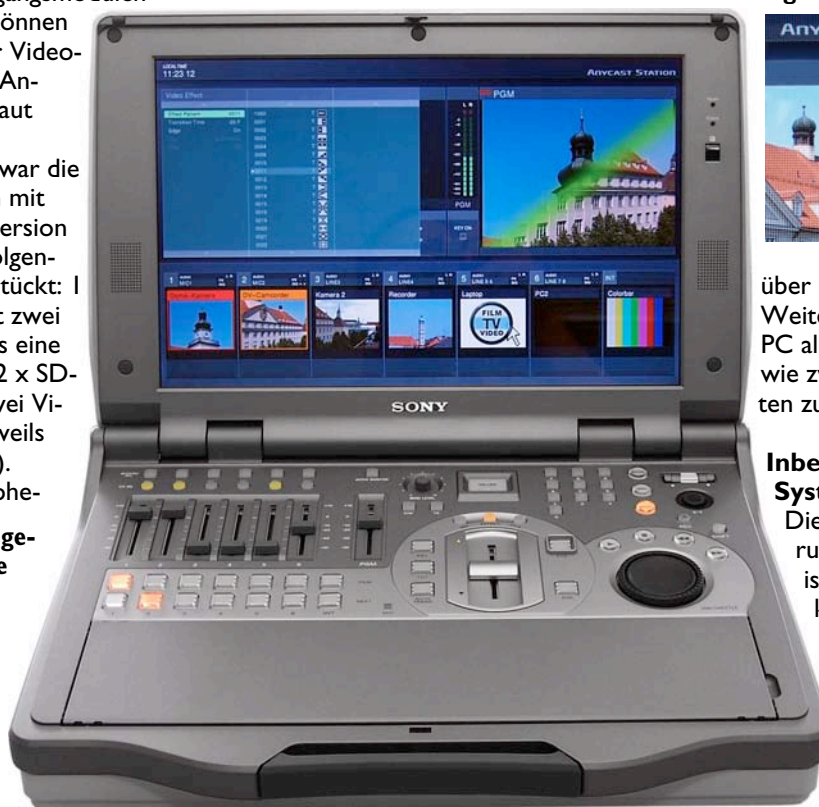
Die Tastatur kann herausgenommen werden, bleibt aber dank Akku und Infrarot-Verbindung dennoch funktionsfähig.
